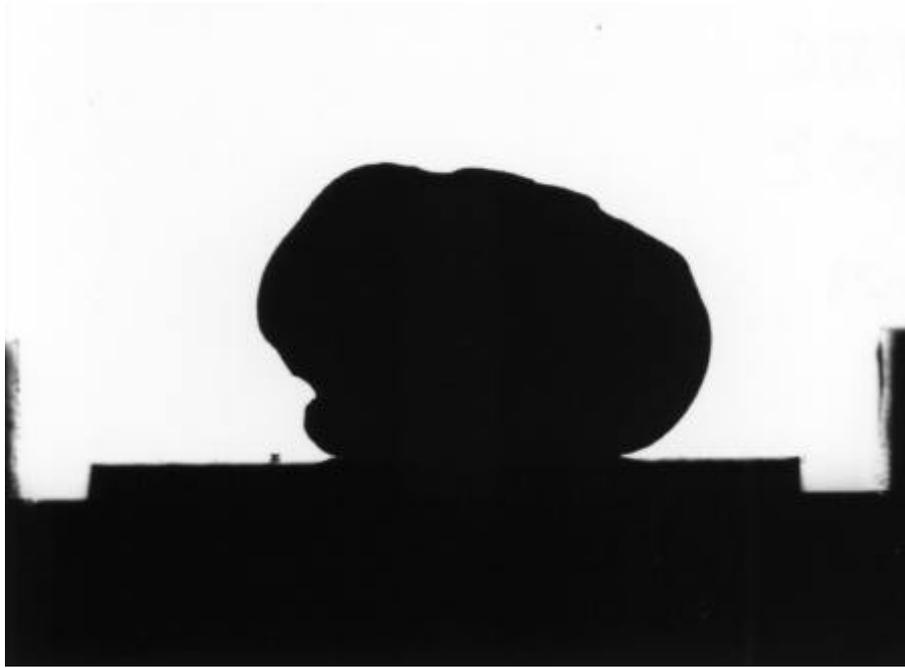
圖 3-26 6061/5% SiC<sub>p</sub> 複材於 850 時之潤濕角測試外觀
