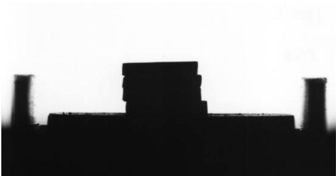
圖 3-29 6061/20% SiC<sub>w</sub> 複材於 1300 時之潤濕角測試外觀
