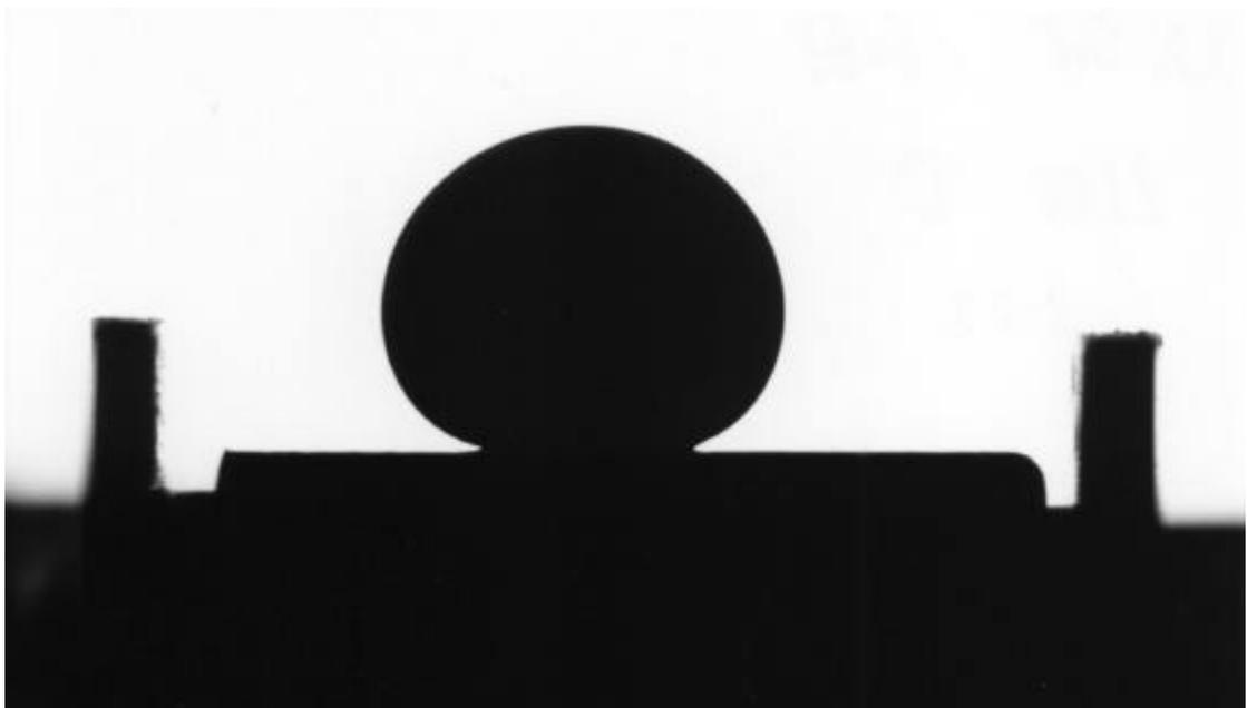
圖 3-25 6061/1% SiC<sub>p</sub> 複材於 1100 時之潤濕角測試外觀
