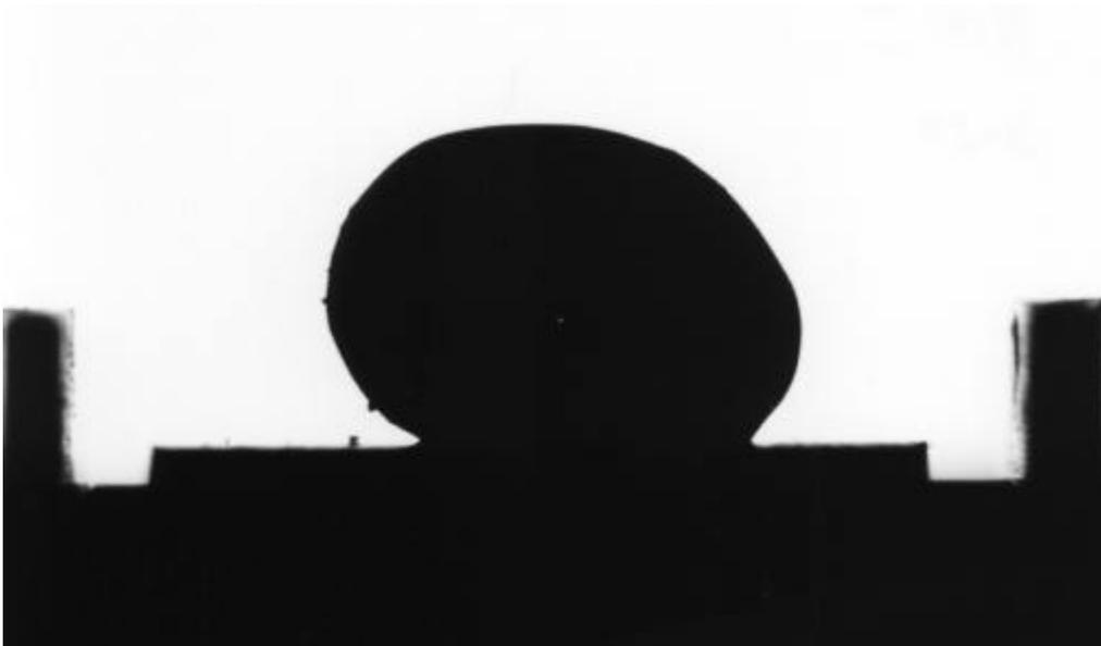
圖 3-27 6061/5% SiC<sub>p</sub> 複材於 1100 時之潤濕角測試外觀
