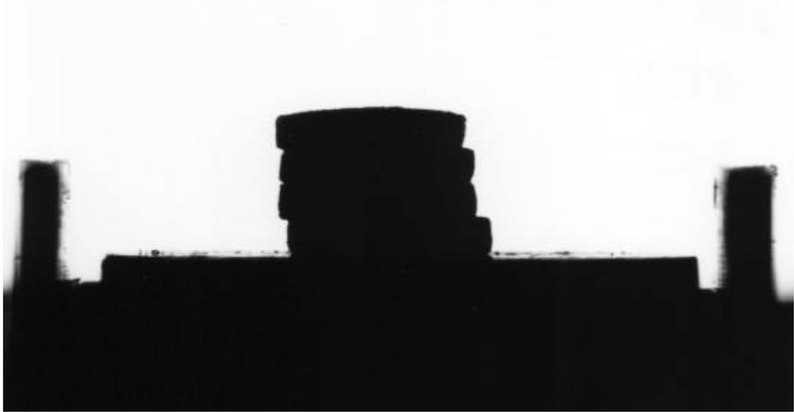
圖 3-28 6061/20% SiC<sub>w</sub> 複材於 850 時之潤濕角測試外觀
